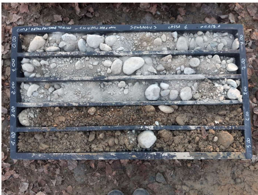
Foto 6: Sondaggio S3 - cassa 1 - da 0.00 m a 5.00 m.
