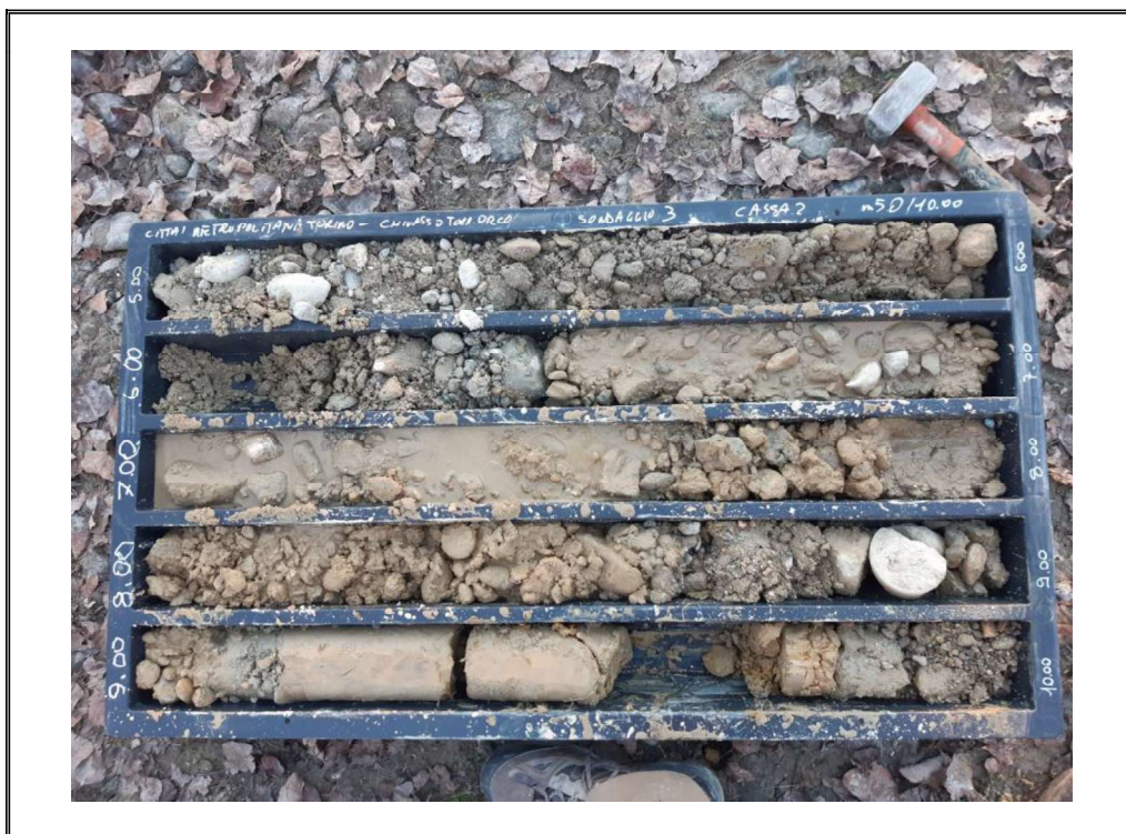
Foto 7: Sondaggio S3 - cassa 2 - da 5.00 m a 10.00 m.
