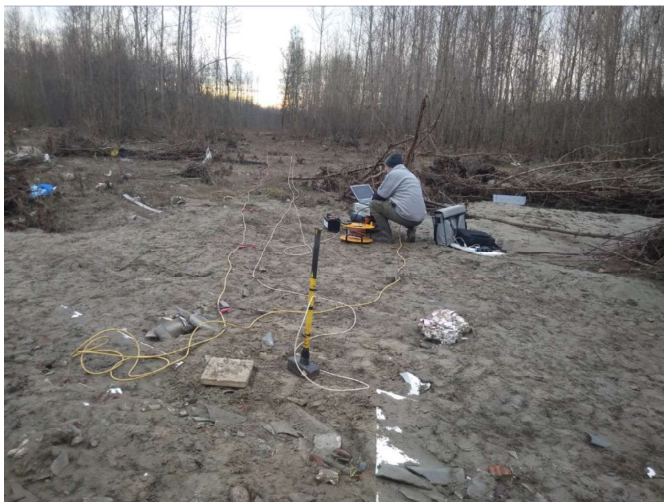
Foto 10: Particolare stendimento prova MASW – Sito di Rivarolo C.se.
