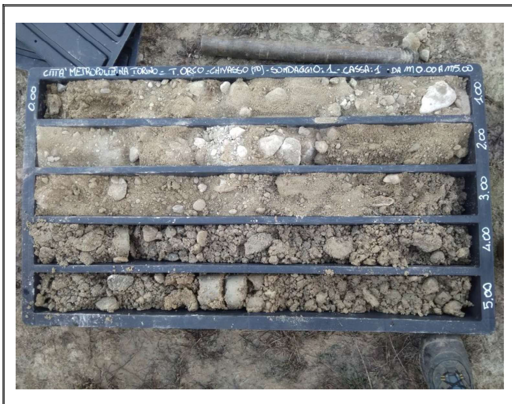
Foto 1: Sondaggio S1 - cassa 1 - da 0.00 m a 5.00 m.
