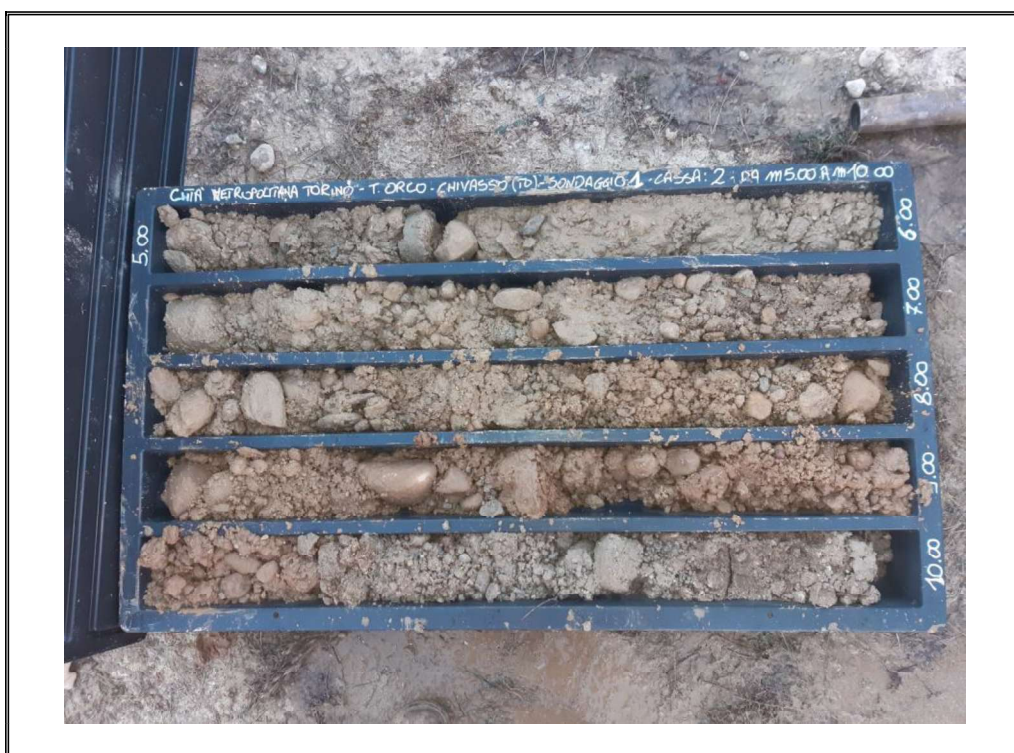
Foto 2: Sondaggio S1 - cassa 2 - da 5.00 m a 10.00 m.
